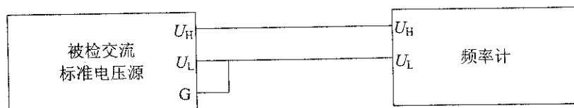
图 5 检定频率示值误差的连接示意图
